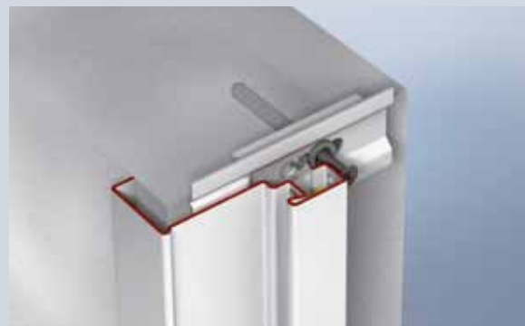
Profil 1 ościeżnicy kątowej przykręcić do konstrukcji ściany szkieletowej
