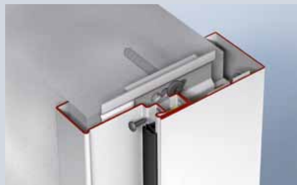
Profil 2 ościeżnicy uzupełniającej przykręcić do profilu 1 przez rowek na uszczelkę i zakryć uszczelką drzwiową
